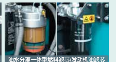
油水分离一体型燃料滤芯/发动机油滤芯
